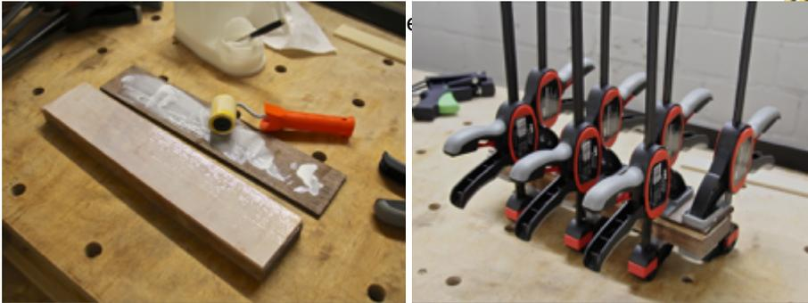
Dann alles dicht mit Klemmen oder Zwingen und richtig viel Druck aufeinander pressen. Überschüssiger Leim sollte mit einem leicht feuchten Tuch entfernt werden, was am besten funktioniert, solange nur die äußeren und eine mittlere Klemme angebracht sind.
