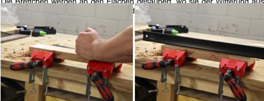
So sind ein dickes Stück für den Schalenkorpus und zwei dünnere für den Zierring und den Schalenrand entstanden. Einmal alles übereinander legen und noch einmal vor dem Verleimen das saubere Aufliegen kontrollieren.
