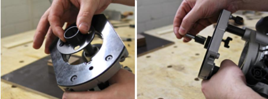
Die Kopierhülse (in meinem Fall ragt sie 8 mm unter dem Fräserfuß hinaus, hat also durch die 9 mm Schablone noch einen Millimeter Luft zum Werkstück) wähle ich im Radius mindestens 2 mm größer als den zu verwendenden Fräskopf.
